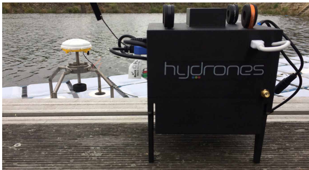
Figure 1 : Prototype d'altimètre léger HyDrones #MK1.1. Au second plan : nappe GPS « CalNaGeo »
