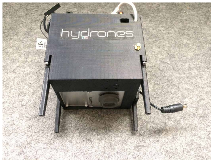
Figure 2 : Prototype HyDrones #MK2 dédié à la bathymétrie
