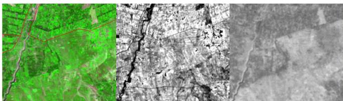
Exemple de l'intérêt de l'imagerie thermique. A gauche, une composition colorée Landsat (TM 3, 4, 7) sur la plaine du Haouz (Maroc), au centre le NDVI et à droite l'image thermique correspondante. Par rapport à la composition colorée et au NDVI, la température accentue le contraste entre les périmètres irrigués (sombres donc froids) et les zones de culture pluviale (claires donc plus chaudes).
