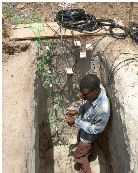
Mesure du profil de température et d'humidité des sols au Bénin © S.Galle
