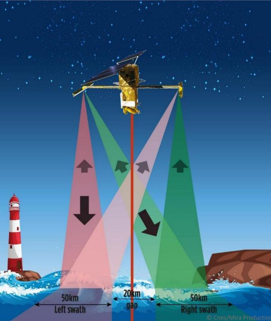
Une des antennes (A2) émet, visant alternativement vers la fauchée gauche et droite, chacune avec une polarisation différente de l'onde radar émise.
