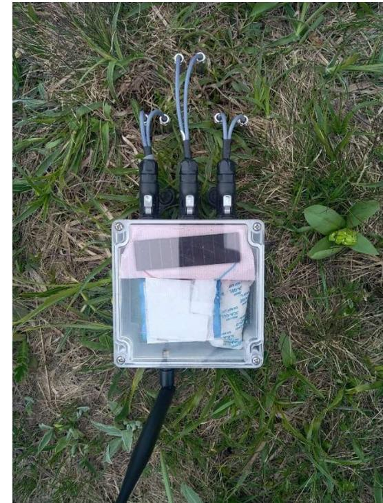
Capteur Humidité / Température
